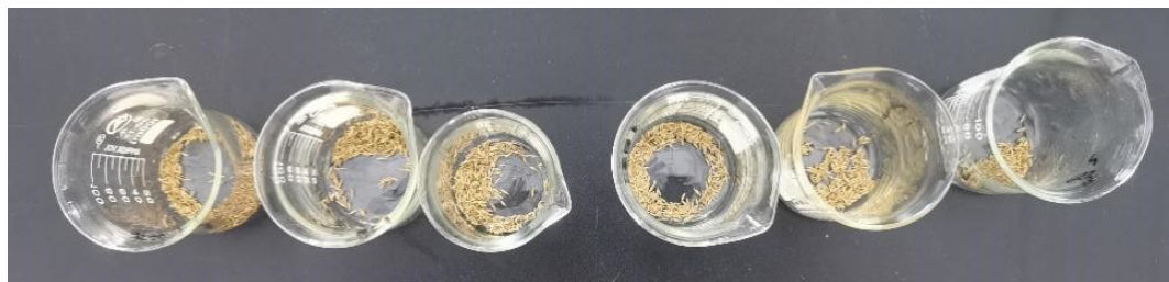
Fig. 2. Experiment on water absorption of kok-saghyz seeds Рис. 2. Эксперимент по водопоглощению семян кок-сагыза
